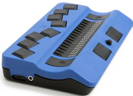
Mit dem Actilino können zudem bis zu vier Geräte parallel bedient werden. Drei, z. B. Smartphones oder Tablets, per Bluetooth und zusätzlich dazu einen PC per USB.
