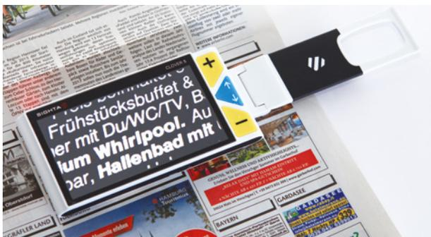
Die Funktionen lassen sich über wenige, große und übersichtlich angeordnete Tasten bedienen. Mit der Plustaste für Vergrößerung und der Minustaste für Verkleinerung lässt sich die Vergrößerung einfach einstellen. Mit den Pfeiltasten können Sie die Farbkombination der Darstellung entsprechend Ihrer Bedürfnisse auswählen. Diese Einstellung merkt sich Clover 5 beim Ausschalten.
